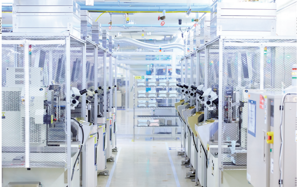
落下塵対策に気流のコントロールを導入。各ブースの上にクリーンユニットを設置し、ダウンフローによる陽圧を実現
