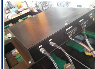
インピーダンス測定装置外観 (サイズ：300x370x60)
